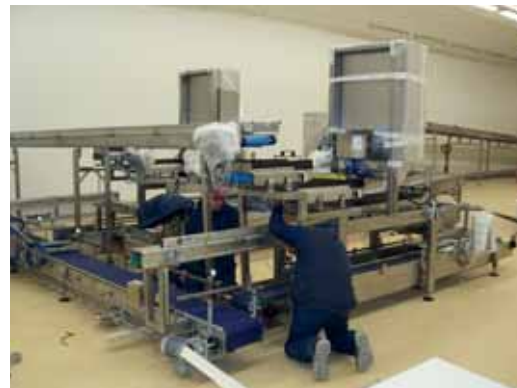
In november is begonnen met de montage van de Viscon-broedei- en kuikenverwerkingsmachines
